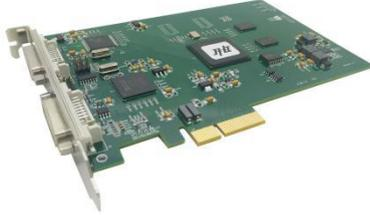
OK\_VGA41A-4E+, 高分辨率图像采集卡, 可采集高分辨的 VGA/DVI/HDMI/S-Video/CVBS 视频信号, 采用 PCI Express×4 总线作为数据传输通道, 最大传输速度达到 650MByte/s, 使图像采集速度更快。
